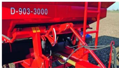
A táblaszéli nyitás és zárás hidraulikus
